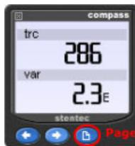
Lo strumento bussola elettronica contiene sia la rappresentazione analogica sia quella digitale della tua rotta. Potrai scambiare la pagina di queste informazioni utilizzando il tasto **Page** (sulla destra dello strumento) e potrai apportare le tue variazioni utilizzando i tasti frecce orizzontali.
