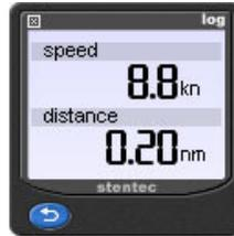
Lo strumento **Log** visualizza la velocità dell'imbarcazione sull'acqua, non quindi il SOG che invece rappresenta la velocità dell'imbarcazione, ma rispetto alla terra ferma, questo valore non tiene conto dello stato del mare, dello scarroccio o della deriva che la barca subisce in un dato momento, i due valori possono anche coincidere in tal caso sull'acqua non vi sono effetti di onda, deriva o scarroccio.
