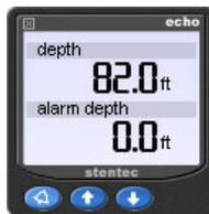
L'ecoscandaglio è un controllore della profondità del mare ed ha anche la possibilità di impostare degli allarmi. Questa funzione può essere attivata premendo sul primo pulsante di sinistra e modificata utilizzando le frecce alta e bassa. Quando la profondità corrente eccede l'allarme impostato lo strumento produce dei beep ed il display dello strumento lampeggerà.
