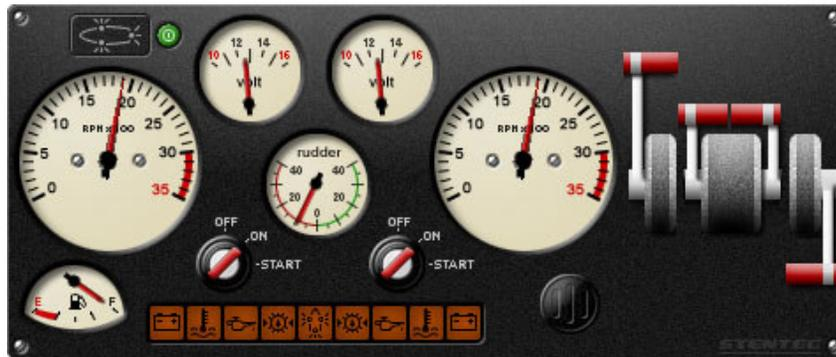
Una speciale sezione comandi (dashboard) è stata creata per il "Koning Willem I". La prima cosa che potrai notare osservandola è la presenza di due leve (maniglie) per ognuno dei propulsori idrogetto. Le maniglie interne servono per controllare il gas dei motori, quindi la loro potenza, quelle esterne servono per controllare i deflettori.
