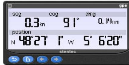
Il ricevitore GPS può essere utilizzato, in combinazione con l'autopilota per timonare e condurre in maniera automatica l'imbarcazione. Quando tracci una rotta sulla carta utilizzando lo strumento Chartplotter, i waypoints che posizionerai, saranno caricati automaticamente nel ricevitore GPS.
