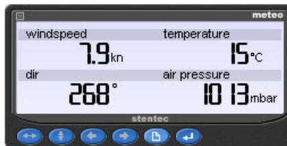
Lo strumento **Meteo** visualizza la velocità del vento e la sua direzione. Lo strumento visualizza anche la temperatura e la pressione atmosferica dell'aria. Premendo il tasto Page (secondo da destra) potrai avere una rappresentazione grafica di questi dati. Con i tasti freccia potrai modificare la rappresentazione di questi dati.
